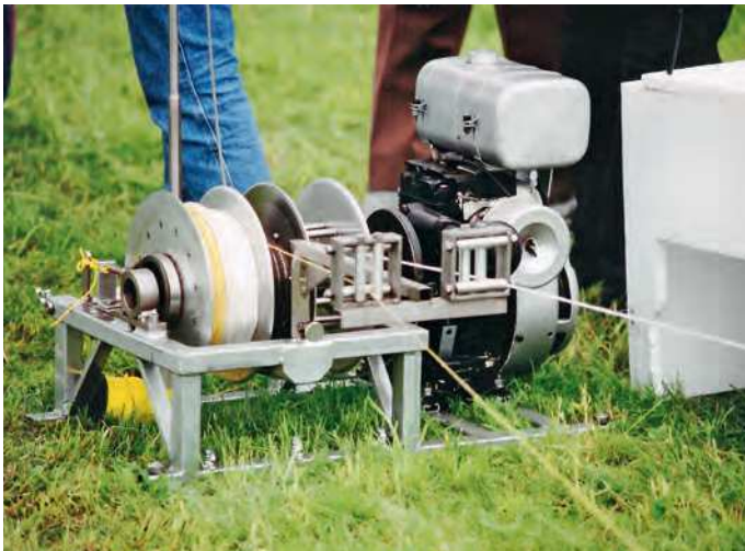
Die Hochstartwinde war rund 30 Jahre im Einsatz. Zuverlässig schleppte sie die Segelmodelle auf die erforderliche Ausgangshöhe. Als sich bei den Modellen der elektrische Eigenantrieb durchsetzte, wurde die Hochstartwinde arbeitslos. Die Segler erreichen nunmehr autonom innert wenigen Sekunden eine Höhe von rund hundert Metern, wo der Antrieb abgeschaltet wird und die Suche nach Thermik beginnen kann.
